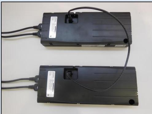
Mit dem SYNC-2 Kabel können zwei Steuerungen miteinander verbunden und synchronisiert werden.
