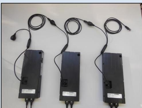
Die SYNC 4 Kabel jeder Steuerung werden miteinander gekoppelt.
