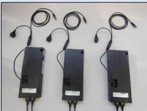
Mit dem SYNC-4 Kabel können 2, 3 oder 4 Steuerungen miteinander verbunden und synchronisiert werden.
