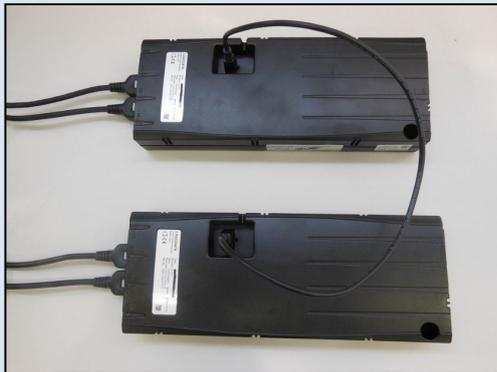
Mit dem SYNC-2 Kabel können zwei Steuerungen miteinander verbunden und synchronisiert werden. Das SYNC-2 Kabel ist 550 mm lang.
