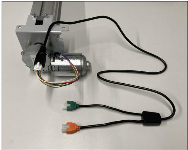
2. Beide Kabel des Motorenkabels in die Kabelzugentlastung legen. Die Biegelasche der Kabelzugentlastung sollte in Richtung Motor zeigen.
