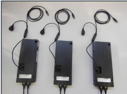
Mit dem SYNC-4 Kabel können 2, 3 oder 4 Steuerungen miteinander verbunden und synchronisiert werden. Das SYNC-4 Kabel ist 1'800 mm lang. Zwei verbundene SYNC-4 Kabel sind 2'000 mm lang.
