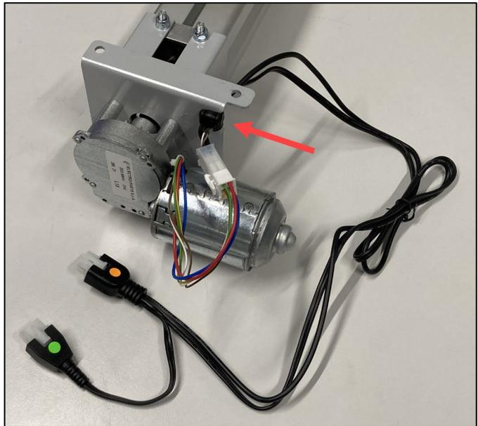
4. Das Kunststoffgehäuse PXD kann nach dem Verkabeln des Motors und nach der Montage der Kabelzugentlastung aufgeschnappt werden.
