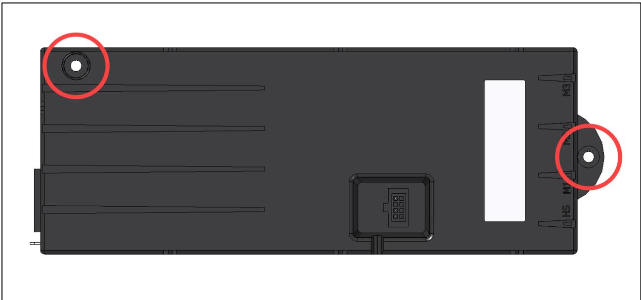
2. Die 2 Löcher vorbohren ( $\varnothing$  3 mm).
