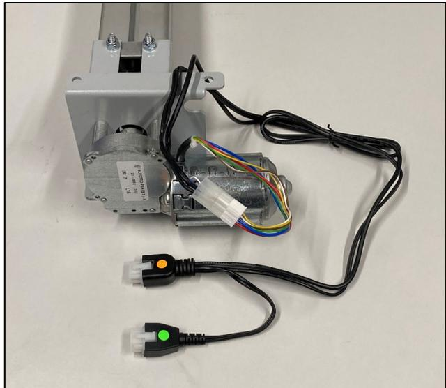
2. Beide Kabel des Motorenkabels in die Kabelzugentlastung legen. Die Biegelasche der Kabelzugentlastung sollte in Richtung Motor zeigen.
