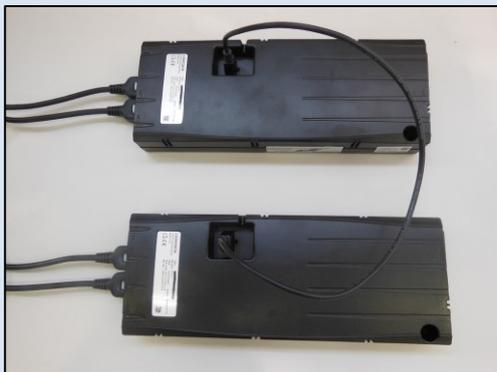
Deux boîtiers de contrôle peuvent être branchés et synchronisés par le câble SYNC-2.
