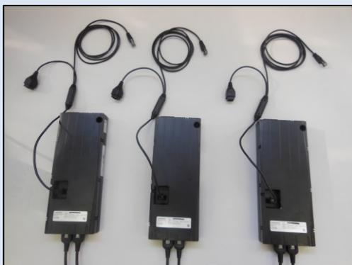
2, 3 ou 4 boîtiers de contrôle peuvent être branchés et synchronisés par le câble SYNC-4
